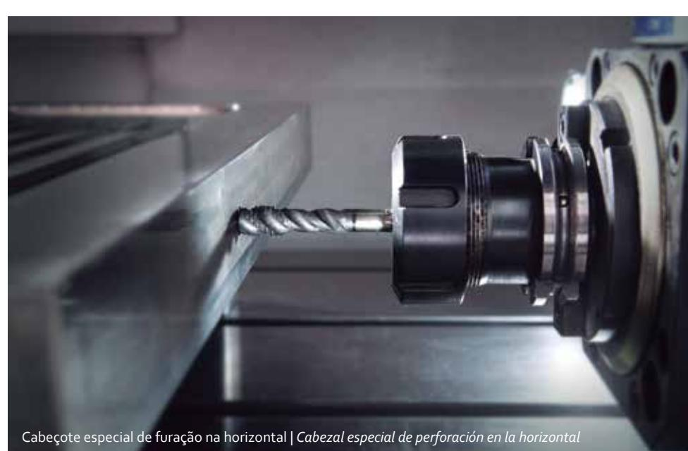
Cabeçote especial de furação na horizontal | *Cabezal especial de perforación en la horizontal*
