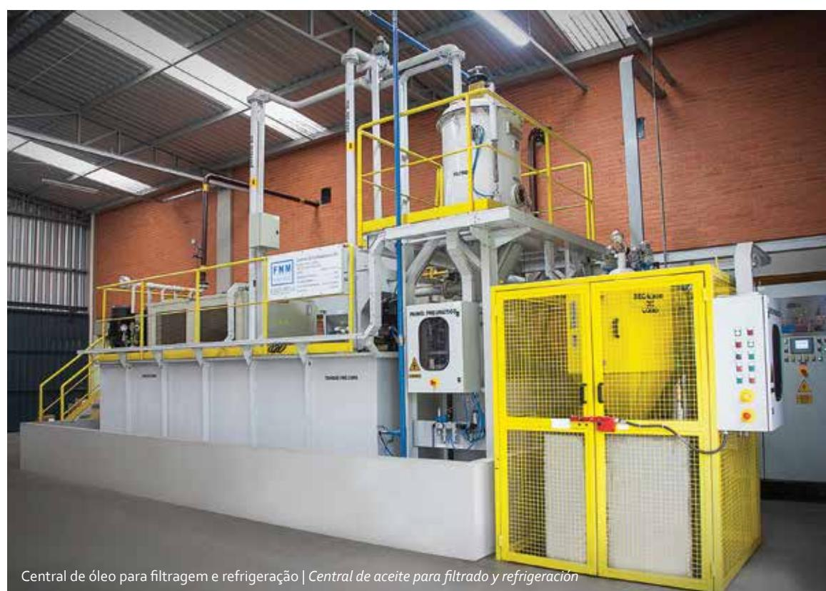
Central de óleo para filtragem e refrigeração | *Central de aceite para filtrado y refrigeración*
